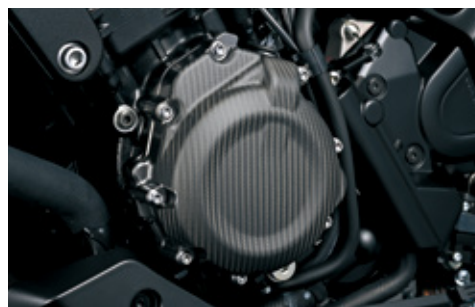
Carbon Lichtmaschinenabdeckung 990D0-04K20-CRB Wird auf dem bestehenden Deckel montiert, mattiert.
