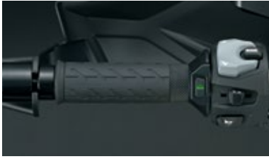
Griffheizung 57100-25820-000 Mit drei verschiedenen Heizstufen, komplette Oberfläche beheizt.
