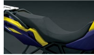
Niedriger Sitz 45100-25LC0-CKA Für Fahrer, die eine niedrigere Sitzhöhe wünschen, ersetzt dieses Zubehörteil den Originalsitz durch einen 20 mm niedrigeren Sitz.
