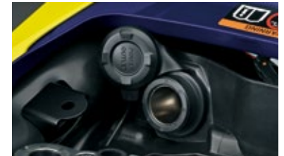
12 V-Steckdose 38800-31810-000 Bietet die Möglichkeit, elektrische Geräte zu verwenden. Wird unter dem Sitz installiert.
