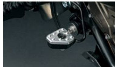
Bremspedalerhöhung 43100-25810-000 Originales Suzuki Design, leicht zu ändernde Bremspedalhöhe, 10 mm höher als bei der Erstausrüstung. Erleichtert den Fahrern das Fahren unter verschiedenen Straßenbedingungen.
