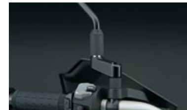
Spiegelverbreiterung 56700-25820-000 Ermöglicht die Spiegel nach den eigenen Wünschen in der Höhe (50 mm) und in der Breite (40 mm) im Vergleich zur Serie anzupassen. *Das Set beinhaltet die Adapter für beide Spiegel. Erforderliche Distanzstücke für die Montage (p/n 56000-25810-000).
