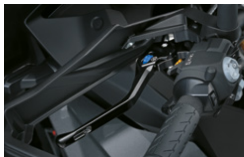
Aluminium-Kupplungshebel (eloxiert) 57600-48810-000 Gefertigt aus hochwertigem Billet-Aluminium, verziert mit GSX-S Logo (vorne) und Suzuki "S" Logo. Diese schwarz eloxierten Hebel sorgen für einen noch sportlicheren Look. Auslieferung mit je zwei Hebelverstellern in Blau und Rot, die wahlweise verwendet werden können.
