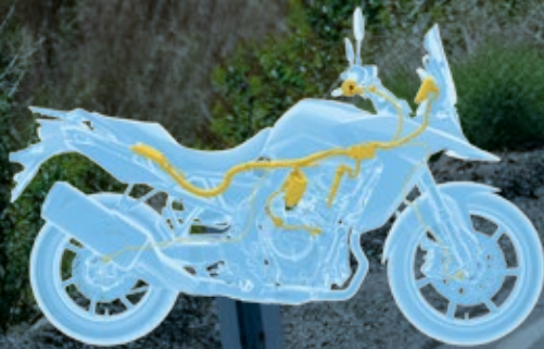
Schematische Darstellung des Suzuki Traction-Control-Systems
