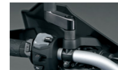
Distanzstücke für Spiegelverbreiterung 56000-25810-000 In Kombination mit der Spiegelverbreiterung (p/n 56700-25820-000).
