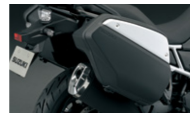
Seitenkoffer-Set aus Kunststoff 95400-25810-000 Maximale Zuladung jeweils 5 kg und Kofferkapazität 26 L (rechts) und 29 L (links). Nur bei Geschwindigkeiten bis 130 km/h verwenden. In Kombination mit Halterung (p/n 47500-25810-000/93700-25880-000) und Schloss-Set (p/n 95700-48810-000/95700-48820-000).
