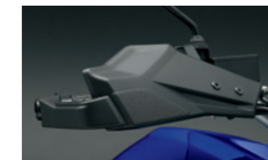
Handprotektoren 57300-25810-000 Hilft, die Hände vor Wind zu schützen. Ermöglicht die Spiegel nach den eigenen Wünschen in der Höhe (50 mm) und in der Breite (40 mm) im Vergleich zur Serie anzupassen. sind zusätzlich die Distanzstücke (p/n 56000-25810-000) erforderlich.
