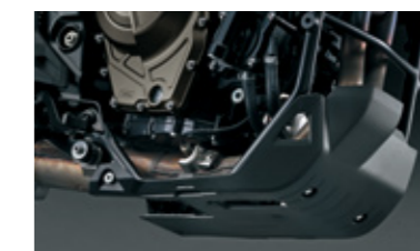
Abdeckung 94400-25830-000 Zusätzliche Option zum Schutz des Motors. In Kombination mit Rahmenunterzug (p/n 41100-25810-000).
