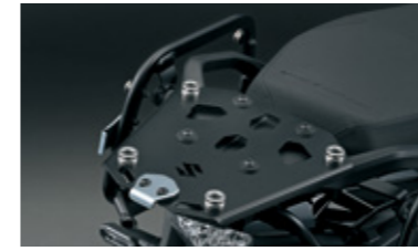
Topcase-Trägerplatte 93800-25850-000 Das Topcase-Trägerset ist nur für die Montage des Aluminium-Topcase (p/n 93100-25840-000/93100-25860-000) vorgesehen. Nicht für andere Zwecke verwenden.
