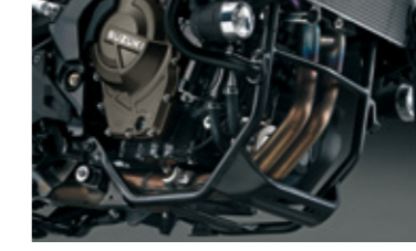
Rahmenunterzug 41100-25810-000 Erforderlich für die Montage des Sturzbügel (94200-25810-000), Aluminium Unterfahrschutz (p/n 42500-25830-000) oder der Abdeckung (p/n 94400-25830-000).
