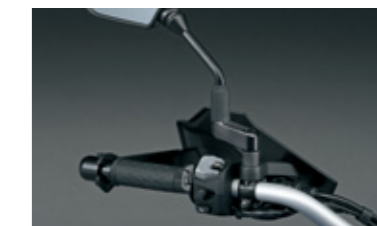
Spiegelverbreiterung 56700-25820-000 Ermöglicht die Spiegel nach den eigenen Wünschen in der Höhe (50 mm) und in der Breite (40 mm) im Vergleich zur Serie anzupassen. *Das Set beinhaltet die Adapter für beide Spiegel. Erforderliche Distanzstücke für die Montage (p/n 56000-25810-000).
