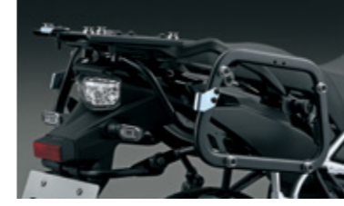
Seitenkofferträger 93700-25860-000 Erforderlich für die Montage des Aluminium-Seitenkoffersatzes (p/n 95400-25840-000/95400-25870-000).
