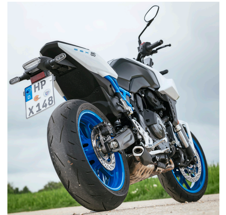
Ein großer Vorschalldämpfer ermöglicht ein kleines Endrohr, dem ein angenehmer Klang entweicht. So bleibt die Silhouette schön schmal
