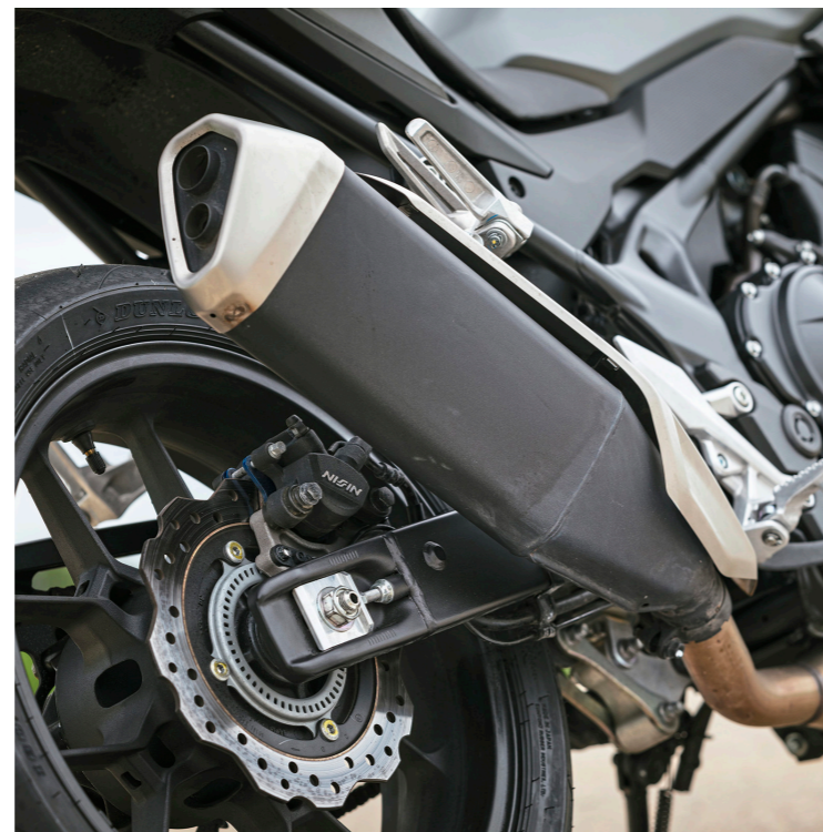
Als Einzige trägt die Hornet einen konventionellen Endschalldämpfer. Schwinge und Hebelsystem zeugen von nüchterner Verarbeitung
