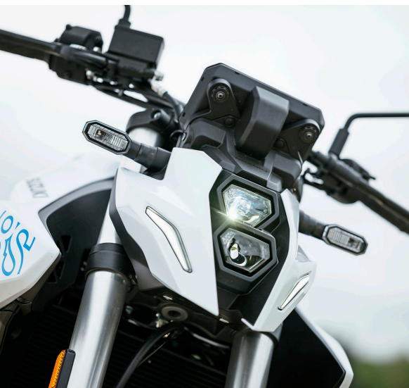
LED-Technik ermöglicht knapp bemessene Scheinwerfer mit ordentlicher Ausleuchtung
