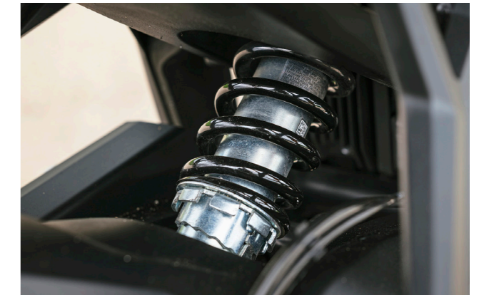
Das Federbein mit zu weicher Feder. Mit der geringsten Vorspannung, die hier zu sehen ist, sollte man nicht fahren
