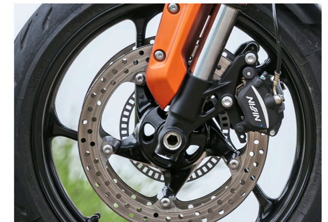
Als Einzige trägt die Trident Doppelkolben-Schwimmsättel. Der Bremsleistung tut das keinen Abbruch
