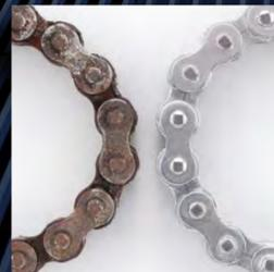
Eine verschlissene Kette greift nicht mehr optimal in die Verzahnung der Zahnräder. Hierdurch können eine ungleichmäßige Kraftübertragung sowie mechanische Verluste auftreten, die zu einem erhöhten Kraftstoffverbrauch führen.
