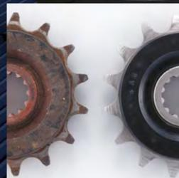
Ein abgenutztes vorderes Ritzel kann die Kette beschädigen. Als Folge können eine ungleichmäßige Kraftübertragung sowie mechanische Verluste auftreten, was zu erhöhtem Kraftstoffverbrauch führt.
