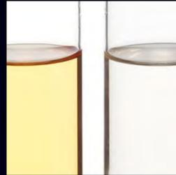
Gealterte Bremsflüssigkeit hat einen niedrigeren Siedepunkt. Dies kann zu einer Dampfblasenbildung führen und so die Bremsleistung beeinträchtigen.
