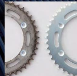
Ein verschlissenes hinteres Kettenrad kann die Kette beschädigen. Als Folge können eine ungleichmäßige Kraftübertragung sowie mechanische Verluste auftreten, die zu einem erhöhten Kraftstoffverbrauch führen.
