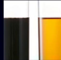
Altes Motoröl erhöht den Kraftstoffverbrauch, die Motorgeräusche und den Verschleiß. Funktionsstörungen und Motorschäden können die Folge sein. Fahren mit zu niedrigem oder zu hohem Ölstand kann den Motor schädigen.
