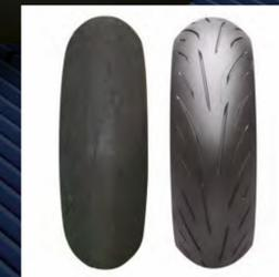
Abgefahrte Reifen können Wasser auf der Fahrbahn nicht mehr ausreichend verdrängen. Dies kann schon bei nur wenig feuchter Straße zu einem Rutschen der Reifen führen.
