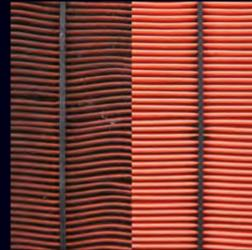
Ein verschmutzter Luftfilter reduziert den Luftdurchsatz. Das führt zu einem erhöhten Kraftstoffverbrauch und kann das Laufverhalten des Motors beeinträchtigen.
