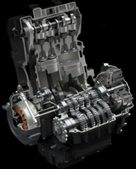
776cm 3 , 4-Takt, 2-Zylinder, Flüssigkeitskühlung, DOHC, Parallel-Twin
