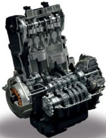
776cm<sup>3</sup>, 4-Takt, 2-Zylinder, Flüssigkeitskühlung, DOHC, Parallel-Twin
