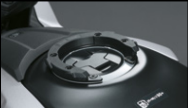
Ringbefestigung für Tankrucksack 44200-25810-000 Zur Befestigung des Tankrucksacks (p/n 99143-00A01-000 oder 99143-00A11-000).
