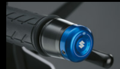
Lenkerendgewichte (Blau) 56200-25870-000 Gefertigt aus Stahl und Aluminium; mit Suzuki "S" Logo. Satz für rechte und linke Seite.
