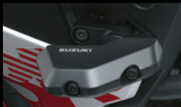
Frame Slider Set 41900-25850-000 Die Slider auf beiden Fahrzeugseiten sind durch eine Stange miteinander verbunden, was der Konstruktion höchste Festigkeit verleiht und die Schutzwirkung bei einem Sturz maximiert. Mit Suzuki Logo, Satz für rechte und linke Seite.
