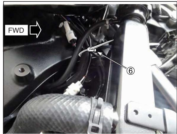
20. Braquer le guidon vers la gauche et la droite et vérifier que tous les faisceaux de câbles sont tendus et n'interfèrent pas avec le véhicule. Si le faisceau de câbles gêne la manœuvre du véhicule, le réarranger et le fixer en place à l'aide de l'attache de rechange ⑥.
