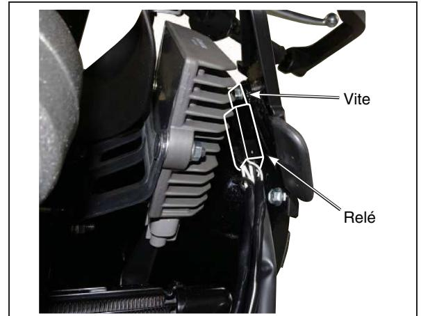
5. Far passare il cablaggio di alimentazione, il cablaggio dell'interruttore e il cablaggio della lampada RH del set fascio fili relè ② dal basso della parte laterale sinistra anteriore del serbatoio del carburante verso la parte laterale destra anteriore del veicolo attraverso la staffa centrale anteriore.
