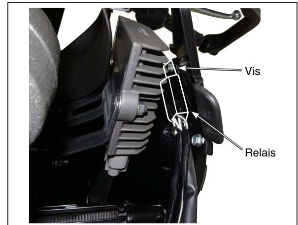
5. Faire passer le faisceau électrique, le faisceau du contacteur et le faisceau de câbles du phare côté droit du faisceau de câbles du relais ② de sous le côté avant gauche du réservoir de carburant à la partie avant droite du véhicule en passant par le support central avant.
