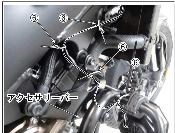
12. [左側] LED ランプ（部品①）のハーネスをアクセサリーバー A とラジエータホースの裏側を通し、アクセサリーバー A 2ヶ所へクランプ（部品⑥）で仮固定してください。
