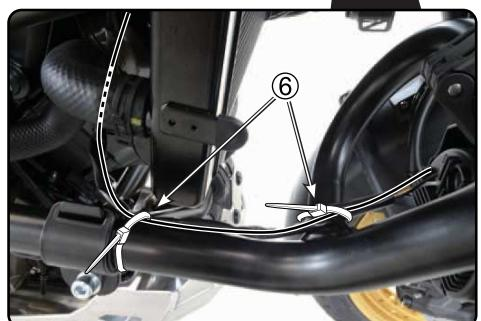
14.[Lado izquierdo] Pase el mazo de cables del faro LED izquierdo ① a través de la parte posterior de la barra de accesorios B y la manguera del bastidor y fije temporalmente el mazo de cables a la barra de accesorios B en 2 puntos utilizando la abrazadera ⑥.
