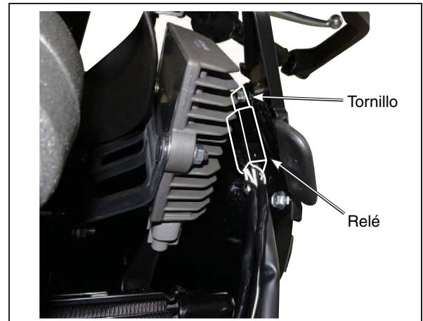
5. Pase el mazo de cables de la fuente de alimentación, el mazo de cables del interruptor y el mazo de cables de la lámpara derecha del conjunto de mazos de cables de relés ② desde abajo de la parte delantera izquierda del depósito de combustible a la parte delantera derecha del vehículo a través del soporte central delantero.
