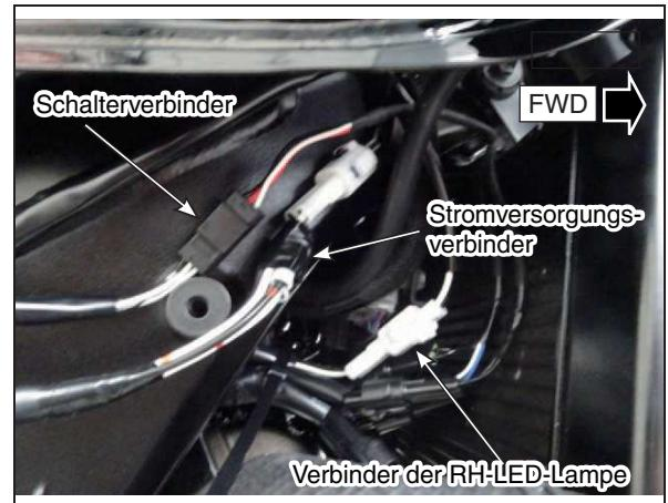
17. Stellen Sie sicher, dass die rechte/linke LED-Lampe und die Beleuchtungsvorrichtungen des Motorrads ordnungsgemäß funktionieren.
