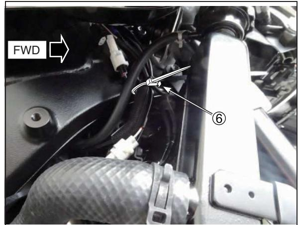
20. Girare il manubrio a sinistra e a destra per controllare che i cablaggi non si tendano e non interferiscano col movimento del veicolo. Se il cablaggio interferisce con il movimento del veicolo, fissarlo per eliminare l'interferenza usandola fascetta di ricambio ⑥.
