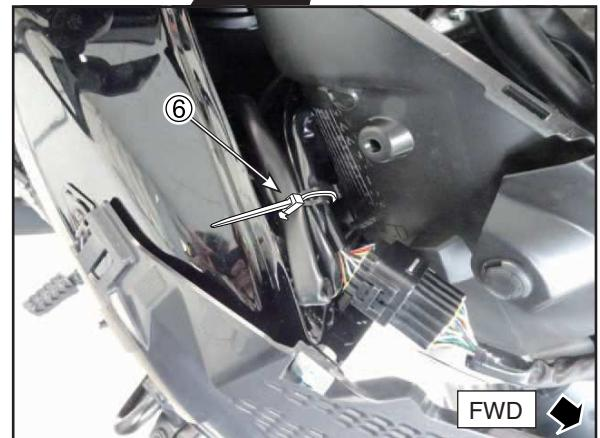
19. Fissare temporaneamente il cablaggio di alimentazione, il cablaggio dell'interruttore e il cablaggio delle lampadine a LED RH del set fascio fili relé ② al cablaggio STD usando la fascetta ⑥ dietro il radiatore, come mostrato nell'immagine.
