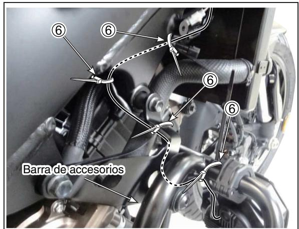
12. [Lado izquierdo] Pase el mazo de cables del faro LED izquierdo ① a través de la parte posterior de la barra de accesorios A y la manguera del bastidor y fije temporalmente el mazo de cables a la barra de accesorios A en 2 puntos utilizando la abrazadera ⑥.
