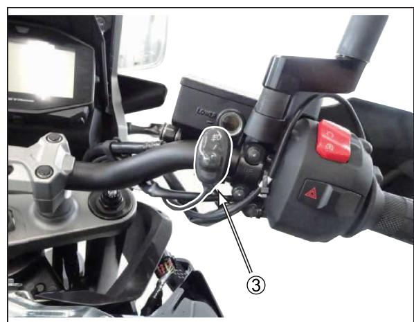
7. Führen Sie den Kabelbaum des Schalters ③ entlang des STD-Kabelbaums durch die Kabelbaumaufhängung und befestigen Sie den Kabelbaum mit der STD-Gummiklemme.
