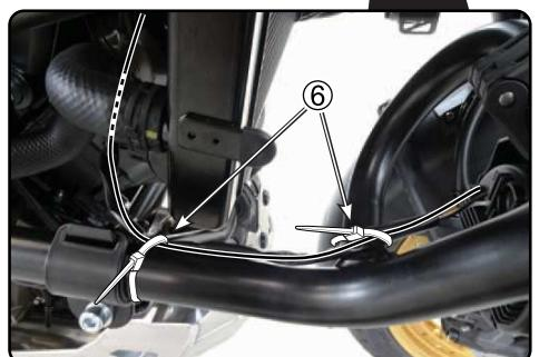
14.[Lato sinistro] Far passare il cablaggio delle lampadine a LED LH ① attraverso la parte posteriore della Barra degli accessori B e il tubo del radiatore, e fissare temporaneamente il cablaggio alla Barra degli accessori B in 2 punti usando la fascetta ⑥.
