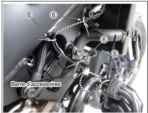
12.[Côté gauche] Faire passer le faisceau du phare à LED gauche ① par l'arrière de la barre d'accès soires A et le flexible du radiateur et fixer temporairement le faisceau sur la barre d'accès soires A en deux points à l'aide de l'attache ⑥.
