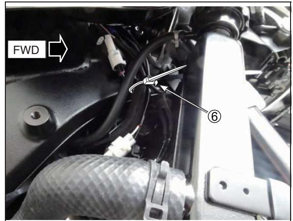
20. ハンドルを左右に切り、ハーネスが突っ張ったり、たるみすぎていたり、車体と干渉しないか確認してください。干渉している場合は、クランプ(部品⑥)で干渉しないように固定してください。
