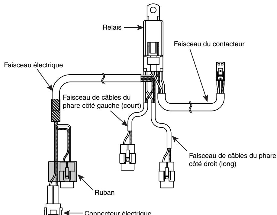
4. Déposer la vis supérieure du cache intérieur avant côté gauche et installer le relais du faisceau de câbles du relais ② à l'aide de la vis supérieure.
