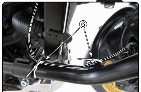
14. [ 左側 ] LED ランプ (部品 ①) のハーネスをアクセサリーバー B とラジエータホースの裏側を通し、アクセサリバー B 2ヶ所にクランプ (部品 ⑥) で仮固定してください。
