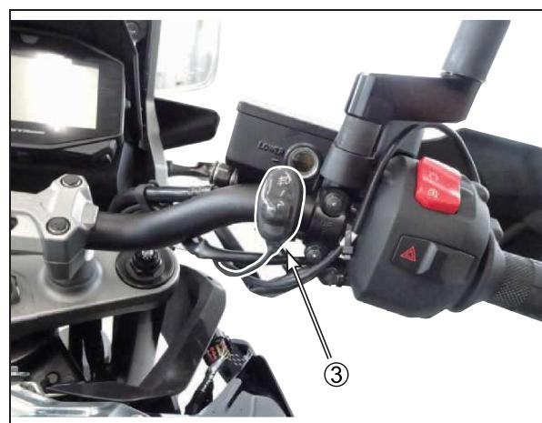
7. Faire passer le faisceau du contacteur ③ le long du faisceau standard via la suspension du faisceau et fixer le faisceau à l'aide de l'attache en caoutchouc standard.
