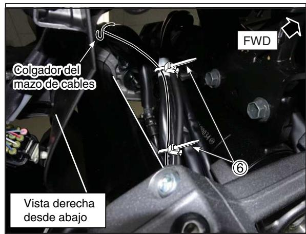
9. Pase el mazo de cables del interruptor ③ a la parte trasera del colgador del radiador a lo largo del mazo de cables STD. (El conector se conectará en el paso (16))
