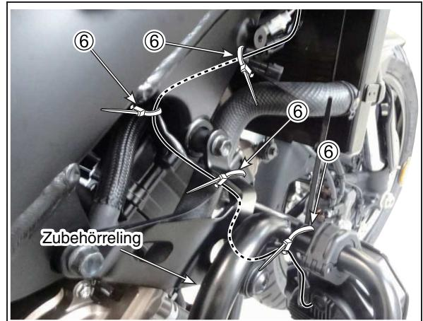
12. [Linke Seite] Führen Sie den Kabelbaum der linken LED-Lampe ① durch die Rückseite der Zubehörreling A und den Kühlerschlauch, und befestigen Sie den Kabelbaum mit dem Kabelbinder ⑥ vorübergehend an 2 Stellen an der Zubehörreling A.
