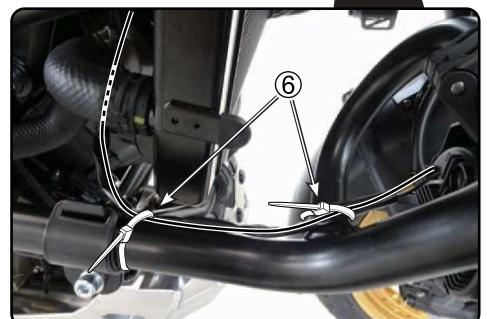
14.[Linke Seite] Führen Sie den Kabelbaum der linken LED-Lampe ① durch die Rückseite der Zubehörreling B und den Kühlerschlauch, und befestigen Sie den Kabelbaum mit dem Kabelbinder ⑥ vorübergehend an 2 Stellen an der Zubehörreling B.
