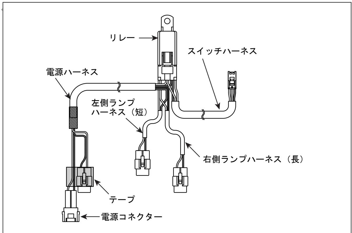
4. 左フロントサイドインナーカバーの上部スクリュを取り外し、取り外したスクリュを使用して、リレーハーネス（部品②）のリレーを固定してください。
