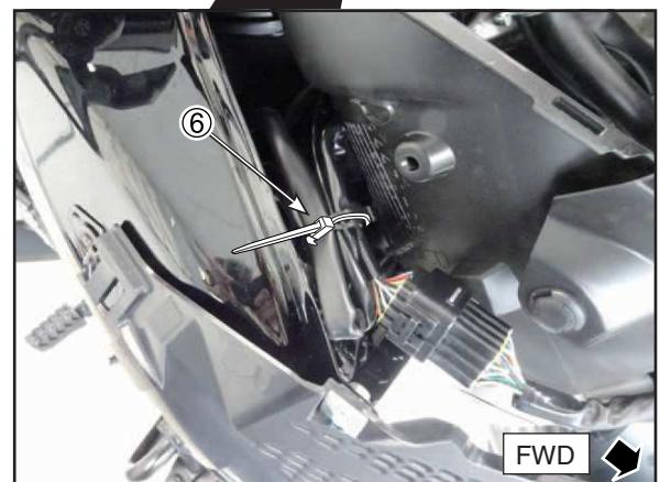
19. Fixer temporairement le faisceau électrique, le faisceau du contacteur et le faisceau du phare à LED côté droit du faisceau de câbles du relais ② sur le faisceau standard à l'aide de l'attache ⑥ à l'arrière du radiateur comme indiqué sur l'image.
