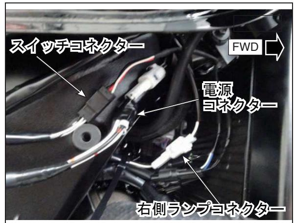
18. リレーハーネス（部品②）の余長を束ねて、車体右側のヘッドランプハーネスに、クランプ（部品⑥）で仮固定してください。
