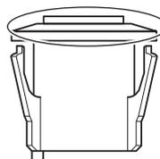
2. Inserte la llave de su motocicleta en el cilindro de la llave y fije la posición del orificio de la llave y la tapa del cilindro de la llave en la línea discontinua, como se muestra.
