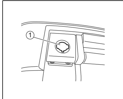
3. Introduzca la llave y gírela hasta que el orificio para la llave ① esté alineado con el saliente ②, como se muestra en la imagen.
