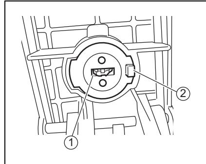
4. トルクス®スクリュ①にネジロック剤を塗布し、ロックプレート②を取り付けます。
