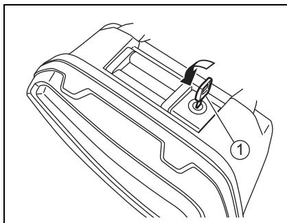
2. Levante la palanca de bloqueo ① y abra la tapa del portaequipajes lateral.
