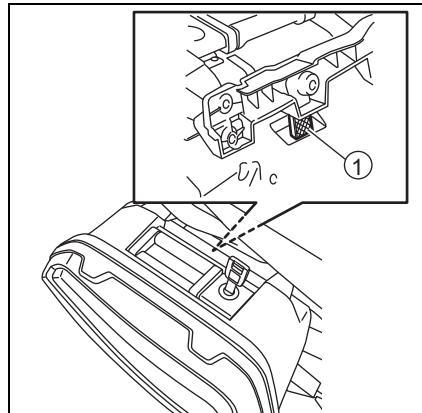
9. Tenere la maniglia e la leva di bloccaggio completamente verso il basso, quindi bloccare il portapacchi girando la chiave.
