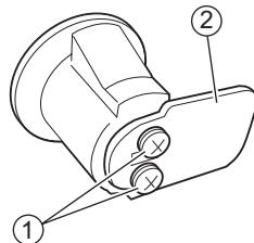
2. Insérer le barillet de serrure dans l'orifice ① de la valise.
