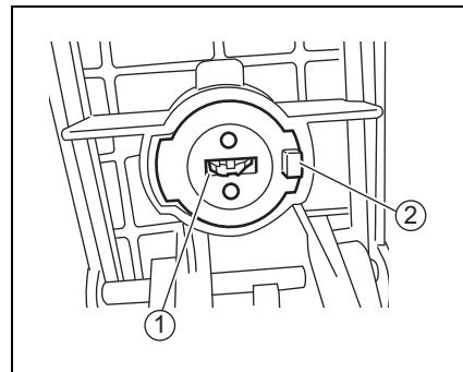
4. Applicare del cemento frenafiletto alle viti TORX® ① e installare la piastra di bloccaggio ② stringendo le viti.
