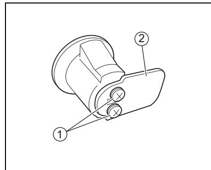
2. Inserire il cilindro della chiave nel foro ① del portapacchi laterale.
