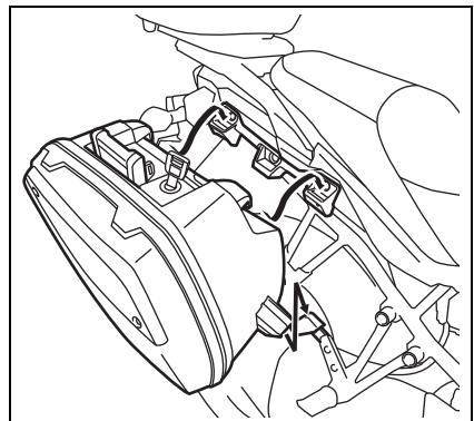
8. ハンドルを折りたたみ、バー①がサイドケースアッパープラケットの溝に固定されていることを確認します。
