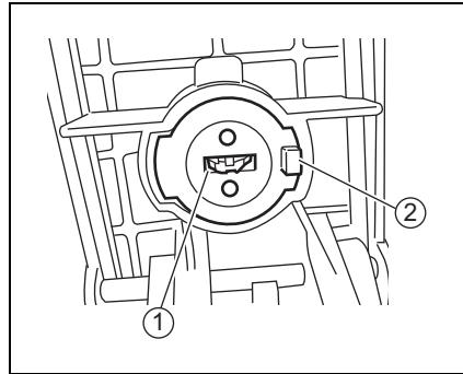
4. Aplique producto de sellado de roscas a los tornillos TORX® ① e instale la placa de bloqueo ② apretando los tornillos.
