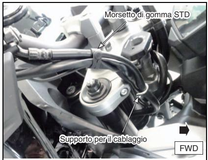
8. Far passare il cablaggio dell'interruttore ③ insieme al cablaggio STD attorno alla forcella anteriore RH. Fissare temporaneamente il cablaggio al cablaggio STD in 2 punti usando la fascetta ⑥.
