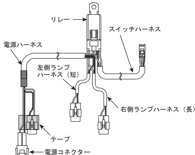
4. 左フロントサイドインナーカバーの上部スクリュを取り外し、取り外したスクリュを使用して、リレーハーネス（部品②）のリレーを固定してください。
