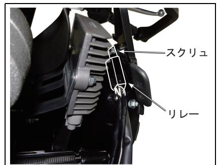
5. リレーハーネス（部品②）の電源ハーネス、スイッチハーネス、右側ランプハーネスをタンク左前側の下から中央前ブラケットを通し、車体右前側へ通してください。
