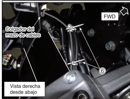
9. Pase el mazo de cables del interruptor ③ a la parte trasera del colgador del radiador a lo largo del mazo de cables STD. (El conector se conectará en el paso (16))
