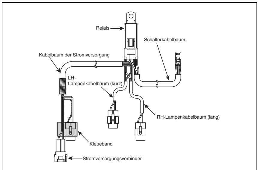
4. Entfernen Sie die obere Schraube der inneren Abdeckung der linken Vorderseite und montieren Sie das Relais des Relaiskabelbaumsets ② mit der oberen Schraube.
