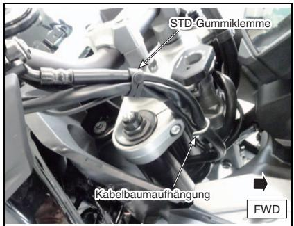
8. Führen Sie den Kabelbaum des Schalters ③ entlang des STD-Kabelbaums um die rechte Teleskopgabel herum. Befestigen Sie den Kabelbaum vorübergehend an 2 Stellen mit dem Kabelbinder ⑥ am STD-Kabelbaum.
