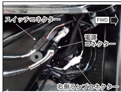
18. リレーハーネス（部品②）の余長を束ねて、車体右側のヘッドランプハーネスに、クランプ（部品⑥）で仮固定してください。
