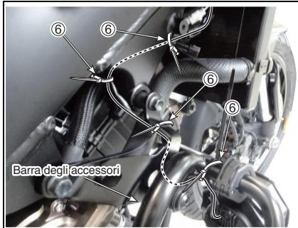
12. [Lato sinistro] Far passare il cablaggio delle lampadine a LED LH ① attraverso la parte posteriore della Barra degli accessori A e il tubo del radiatore, e fissare temporaneamente il cablaggio alla Barra degli accessori A in 2 punti usando la fascetta ⑥.
