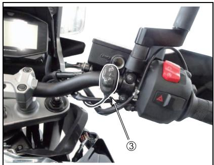
7. Pase el mazo de cables del interruptor ③ a lo largo del mazo de cables STD a través del colgador del mazo de cables y fije el mazo de cables usando la abrazadera de goma STD.
