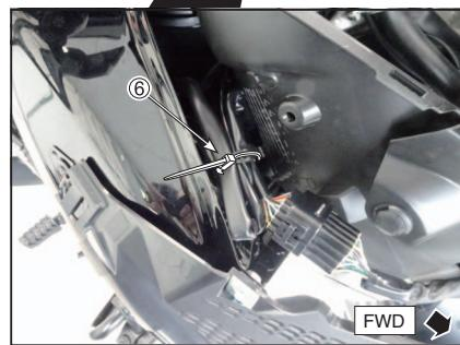
19. Fije temporalmente el mazo de cables de la fuente de alimentación, el mazo de cables del interruptor y el mazo de cables del faro LED derecho del conjunto del mazo de cables de relés ② al mazo de cables STD usando la abrazadera ⑥ en la parte posterior del radiador como se muestra en la imagen.
