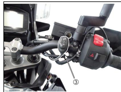
7. スイッチ（部品③）のハーネスを純正ゴムクランプで固定し、ハーネスハンガーに通し、純正ハーネスに沿って配線してください。
