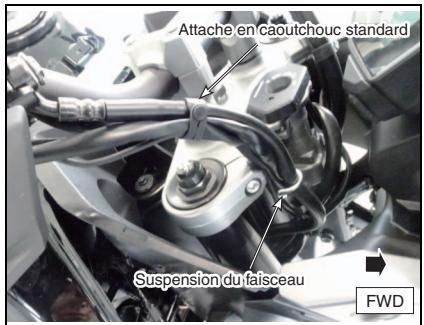
8. Faire passer le faisceau du contacteur ③ le long du faisceau standard autour de la fourche avant droite. Fixer temporairement le faisceau au faisceau standard en deux points à l'aide de l'attache ⑥.
