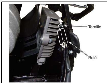
5. Pase el mazo de cables de la fuente de alimentación, el mazo de cables del interruptor y el mazo de cables de la lámpara derecha del conjunto de mazos de cables de relés ② desde abajo de la parte delantera izquierda del depósito de combustible a la parte delantera derecha del vehículo a través del soporte central delantero.
