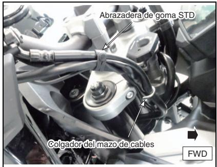
8. Pase el mazo de cables del interruptor ③ a lo largo del mazo de cables STD alrededor de la horquilla delantera derecha. Fije temporalmente el mazo de cables al mazo de cables STD en 2 puntos usando la abrazadera ⑥.
