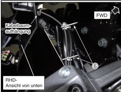
9. Führen Sie den Kabelbaum des Schalters ③ zur Rückseite der Kühleraufhängung entlang des STD-Kabelbaums.
