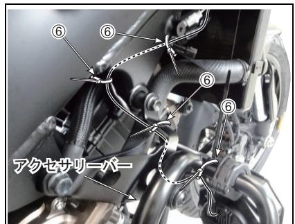
12. [左側] LEDランプ（部品①）のハーネスをアクセサリーバーAとラジエータホースの裏側を通して、アクセサリーバーA2ヶ所へクランプ（部品⑥）で仮固定してください。
