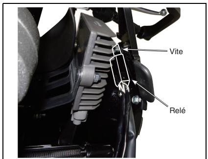
5. Far passare il cablaggio di alimentazione, il cablaggio dell'interruttore e il cablaggio della lampada RH del set fascio fili relè ② dal basso della parte laterale sinistra anteriore del serbatoio del carburante verso la parte laterale destra anteriore del veicolo attraverso la staffa centrale anteriore.
