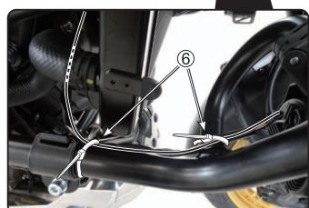
14.[Côté gauche] Faire passer le faisceau du phare à LED gauche ① par l'arrière de la barre d'accessoires B et le flexible du radiateur et fixer temporairement le faisceau sur la barre d'accessoires B en deux points à l'aide de l'attache ⑥.
