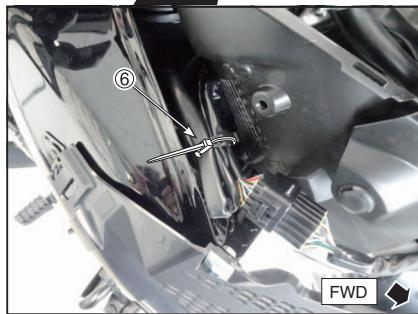
19. Befestigen Sie vorübergehend den Kabelbaum der Stromversorgung, den Schalterkabelbaum und den rechten LED-Lampenkabelbaum des Relaiskabelbaumsets ② am STD-Kabelbaum, indem Sie den Kabelbinder ⑥ auf der Rückseite des Kühlers verwenden, wie im Bild gezeigt.
