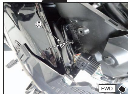
19. 電源ハーネス、スイッチハーネス、右側ランプハーネスをラジエータ裏の写真の位置で 純正ハーネスに、クランプ(部品⑥)で仮固定してください。
