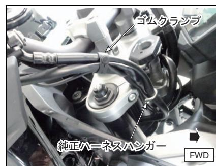
8. 右フロントフォーク付近の純正ハーネスに沿ってスイッチ（部品③）のハーネスを配線し、クランプ（部品⑥）にて純正ハーネス2ヶ所に仮固定してください。
