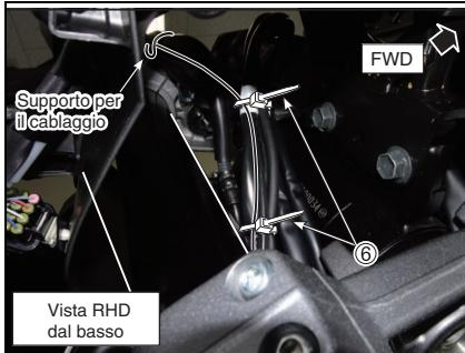
9. Far passare il cablaggio dell'interruttore ③ verso la parte posteriore del supporto per il radiatore insieme al cablaggio STD.
