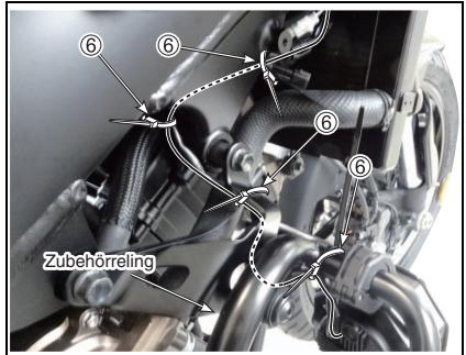
12. [Linke Seite] Führen Sie den Kabelbaum der linken LED-Lampe ① durch die Rückseite der Zubehörreling A und den Kühlerschlauch, und befestigen Sie den Kabelbaum mit dem Kabelbinder ⑥ vorübergehend an 2 Stellen an der Zubehörreling A.
