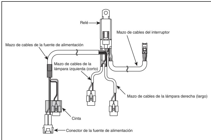
4. Retire el tornillo superior de la cubierta interior de la parte frontal izquierda e instale el relé del conjunto de mazos de cables de relés ② utilizando el tornillo superior.
