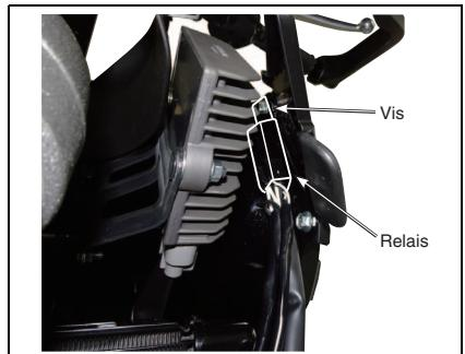
5. Faire passer le faisceau électrique, le faisceau du contacteur et le faisceau de câbles du phare côté droit du faisceau de câbles du relais ② de sous le côté avant gauche du réservoir de carburant à la partie avant droite du véhicule en passant par le support central avant.
