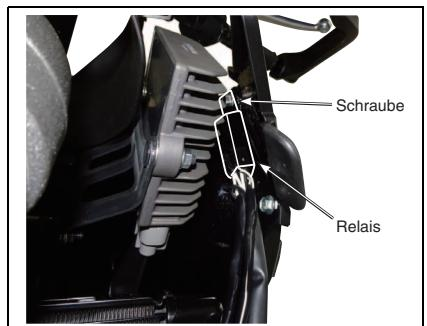
5. Führen Sie den Kabelbaum der Stromversorgung, den Schalterkabelbaum und den rechten Lampenkabelbaum des Relaiskabelbaumsets ② von unter der linken Vorderseite des Kraftstofftanks zur rechten vorderen Seite des Fahrzeugs, und zwar durch die vordere Mittelkonsole.
