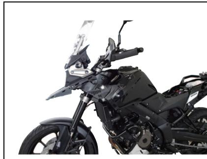
2. ラジエータ裏の車両側電源コネクターから、防水コネクターを取り外してください。
