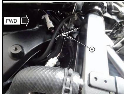
20. Mueva el manillar hacia la izquierda y hacia la derecha y asegúrese de que los mazos de cables no queden bajo tensión ni interfieran con el funcionamiento del vehículo. Si los mazos interfieren con el funcionamiento del vehículo, ajústelos para que no interfieran con el funcionamiento de la motocicleta usando la abrazadera de repuesto ⑥.
