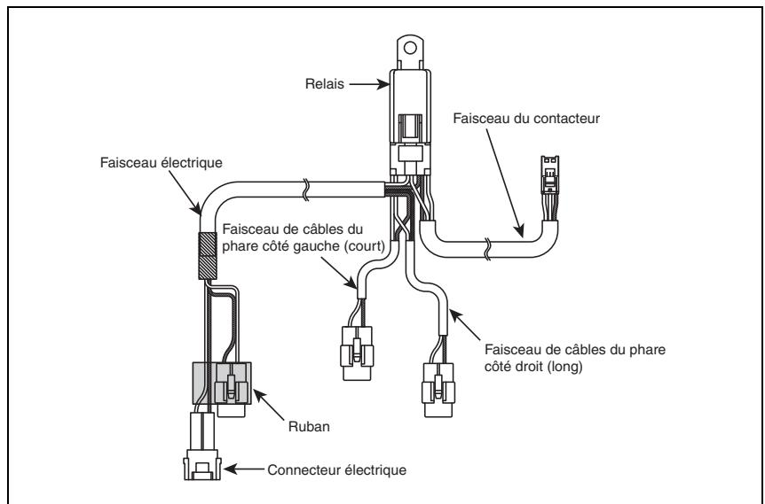
4. Déposer la vis supérieure du cache intérieur avant côté gauche et installer le relais du faisceau de câbles du relais ② à l'aide de la vis supérieure.
