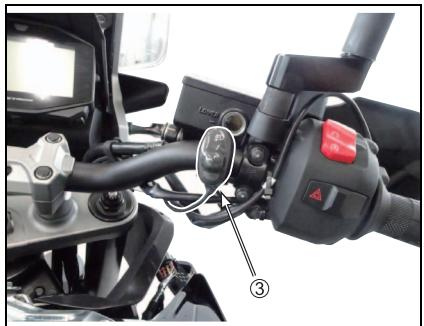
7. Far passare il cablaggio dell'interruttore ③ insieme al cablaggio STD attraverso il supporto per il cablaggio e fissare il cablaggio usando il morsetto di gomma STD.
