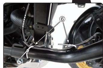
14. [ 左側 ] LED ランプ (部品 ①) のハーネスをアクセサリーバー B とラジエータホースの裏側を通し、アクセサリバー B 2ヶ所にクランプ (部品 ⑥) で仮固定してください。
