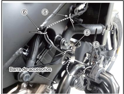
12. [Lado izquierdo] Pase el mazo de cables del faro LED izquierdo ① a través de la parte posterior de la barra de accesorios A y la maniguera del bastidor y fije temporalmente el mazo de cables a la barra de accesorios A en 2 puntos utilizando la abrazadera ⑥.
