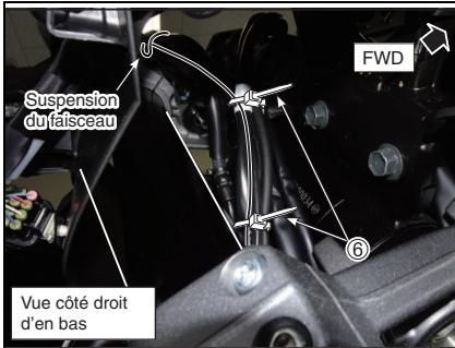
9. Faire passer le faisceau du contacteur ③ à l'arrière de la suspension du radiateur, le long du faisceau standard.
