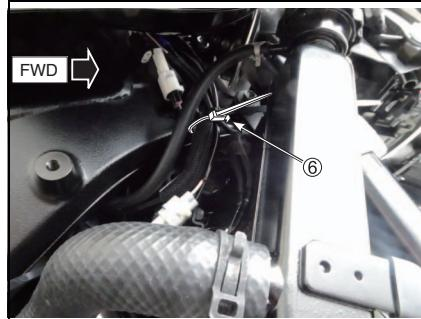
20. ハンドルを左右に切り、ハーネスが突っ張ったり、たるみすぎたり、車体と干渉しないか確認してください。干渉している場合は、クランプ(部品⑥)で干渉しないように固定してください。
